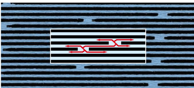
POLARTHERM® SK PLUS ist durch die Bahndicke von 3,8 mm und der verschweißbaren Nahtüberdeckung, durch die doppelte Icopal-Sicherheitsnaht, als Behelfsabdichtung gemäß Flachdachrichtlinie einsetzbar.
